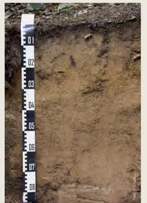
Böden mit Tonverlagerung aus dem Ober- in den Unterboden. Parabraunerden sind in den Lössgebieten Sachsens verbreitet. Sie sind z.T. sehr mächtig und besonders nährstoffreich.
