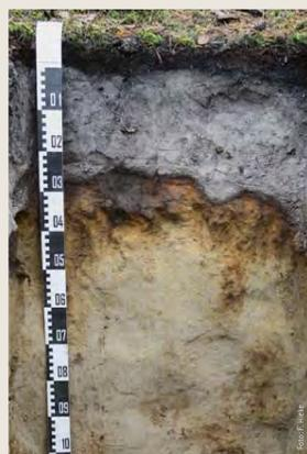
Böden mit Verlagerung von Eisen- und Aluminiumhydroxid sowie Huminstoffen aus dem Ober- in den Unterboden. Podsole sind in den Sandgebieten Nordsachsens und in Gebirgslagen verbreitet.
