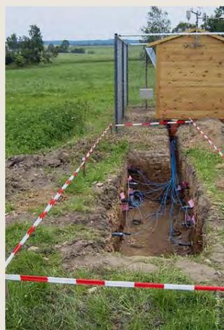
Sensor- und Steuereinrichtung einer instrumentierten Boden-Dauerbeobachtungsfläche
