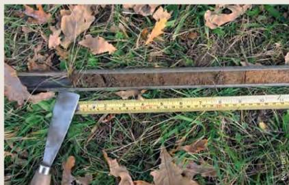
Probenahme mit dem Bohrstock
