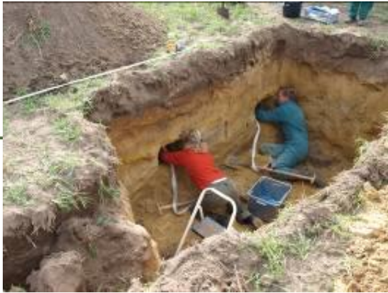
Mitarbeiter der Landwirtschaftskammer und des JKI beim Einbau der Sickerwassersammler in die ungestörte Bodenzone
