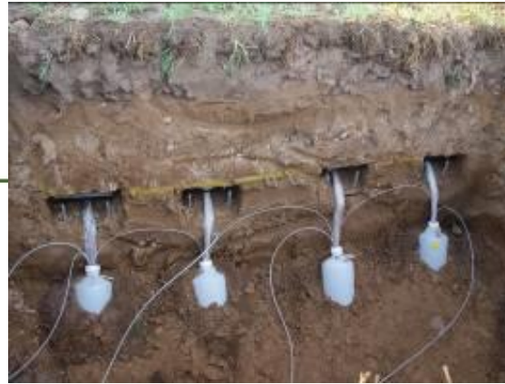
Eingebaute Sickerwassersammler in 80 cm Bodentiefe mit Glasfaserdochten, Sammelflaschen und Absaugschläuchen
