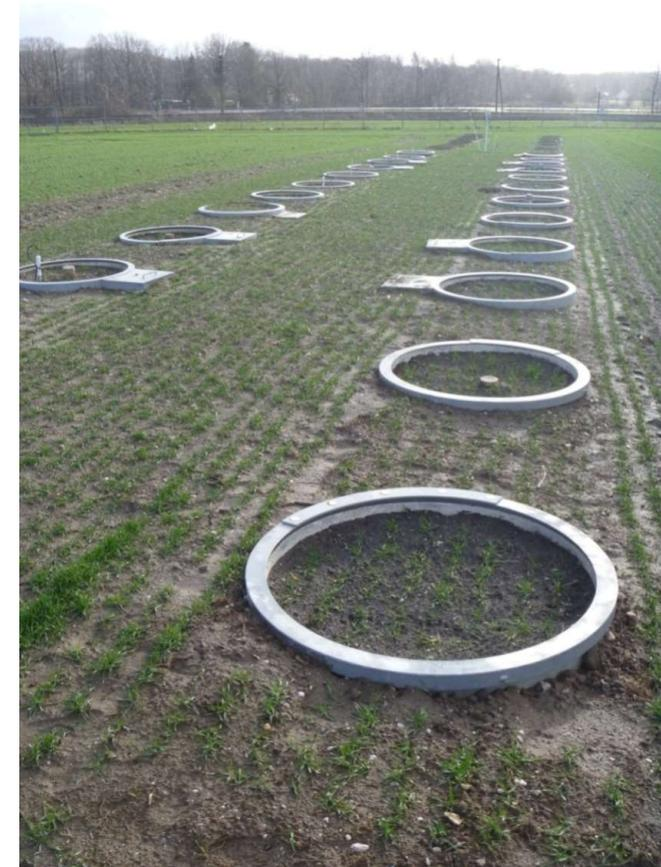
**Abb. 4:** Blick über das Lysimeterfeld mit Lysimetern im Vordergrund und Versickerungsmessern im Hintergrund
