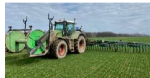
Abb. 1: Durch Gülleverschlauchung lässt sich die mechanische Belastung für den Boden erheblich reduzieren und somit die Ausbringzeit im Frühjahr deutlich erhöhen. (Quelle: LWB Kitzscher)
