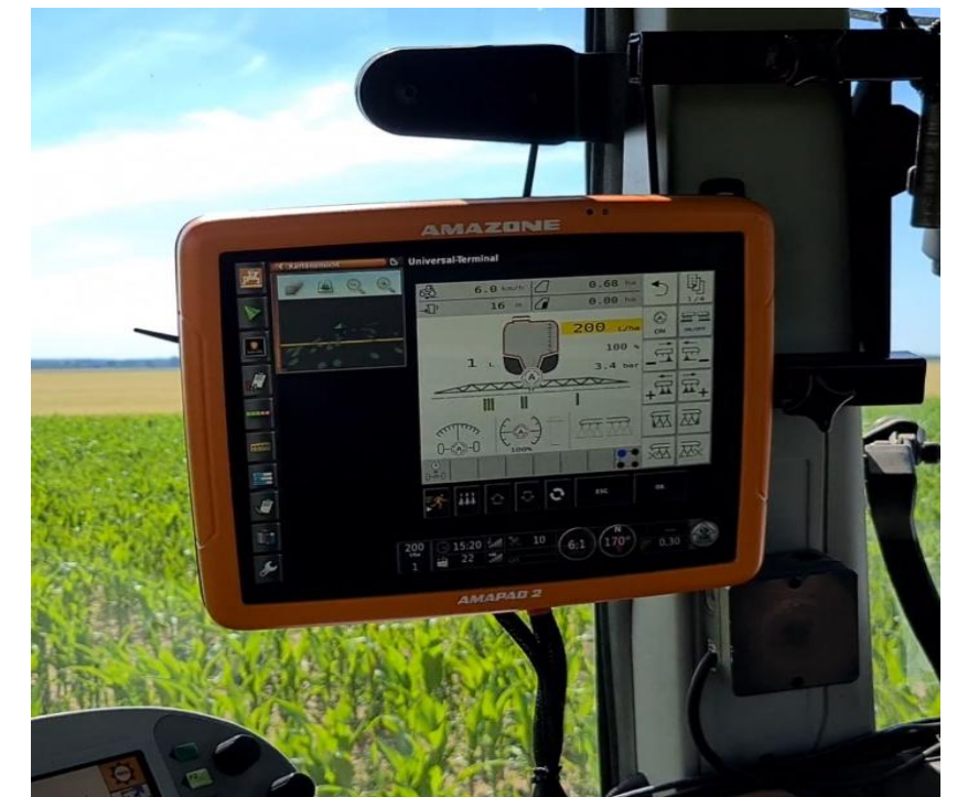
Terminal AMAPAD 2 Terminal während des Spotspraying,
