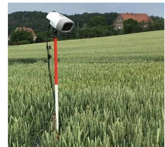
Regelmäßige Erfassung der N-Aufnahme mittels Sensor (YARA ALS2 –Sensorkopf) zur Kalibrierung von Fernerkundungsdaten Quelle: exagt.de
