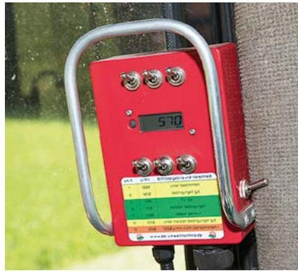
Das Ein- und Ausschalten sowie Ein- und Aussetzen des Mähwerks erfolgt per Schaltpult.
