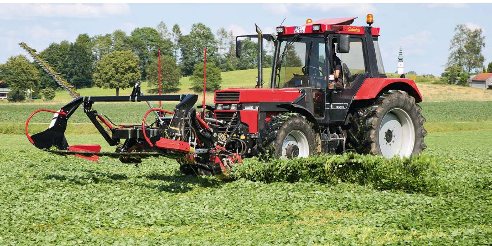
Das dreiteilige Schmetterlings-Mähwerk Seco Duplex gibt es für den Front- und Heckanbau sowie in Arbeitsbreiten bis gut 9 m. Fotos: Zäh
