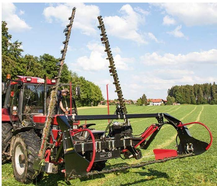
*Ausgehoben und eingeklappt kommt die Mähkombination mit 9 m effektiver Schnittbreite auf eine Transporthöhe von knapp 4 m.*
