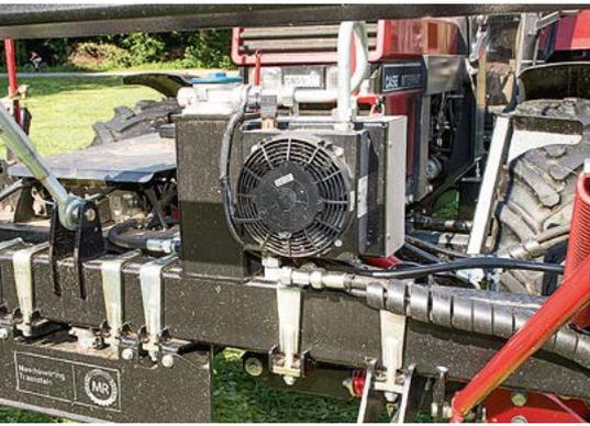
Das Hydrauliksystem mit 62 l Ölvolumen besitzt für den „Ernstfall“ ein Kühlsystem.
