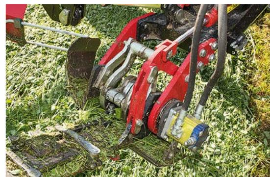
*Der Antrieb der Messer erfolgt über die Bordhydraulik bei 1500 Motorumdrehungen.*
