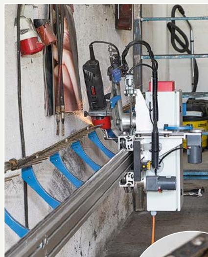
Für 6-m-Messer braucht die Schleifmaschine eine Stunde. Die spezielle Schleifscheibe verhindert das Anlaufen der Klinge.
