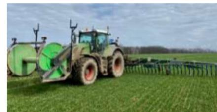
Abb. 1: Durch Gülleverschlachtung lässt sich die mechanische Belastung für den Boden erheblich reduzieren und somit die Ausbringzeit im Frühjahr deutlich erhöhen. (Quelle: LWB Kitzscher)
